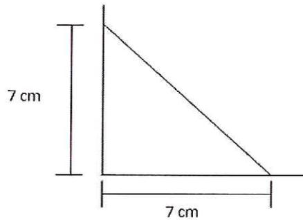
Sur les toitures non isolées avec support en maçonnerie, le chanfrein est réalisé en mortier de ciment.
